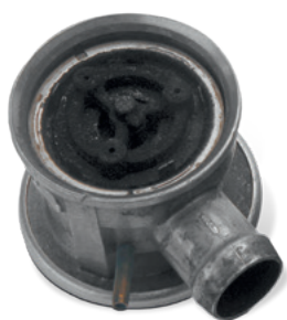
由于尾气冷凝物受损
