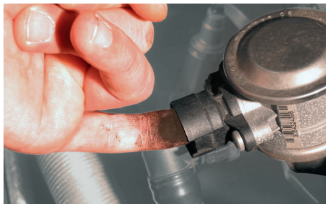
在 BMW 520i 内的二次进气阀上快速检测 (高亮显示)
